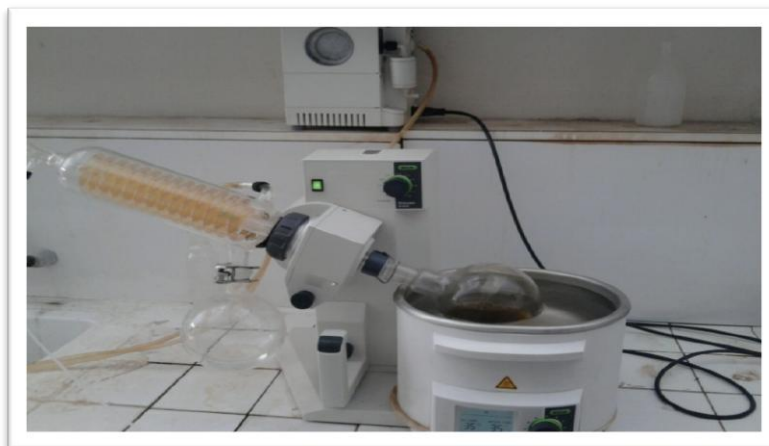
Photo N°9 : évaporateur rotatif (Rotavapor).
